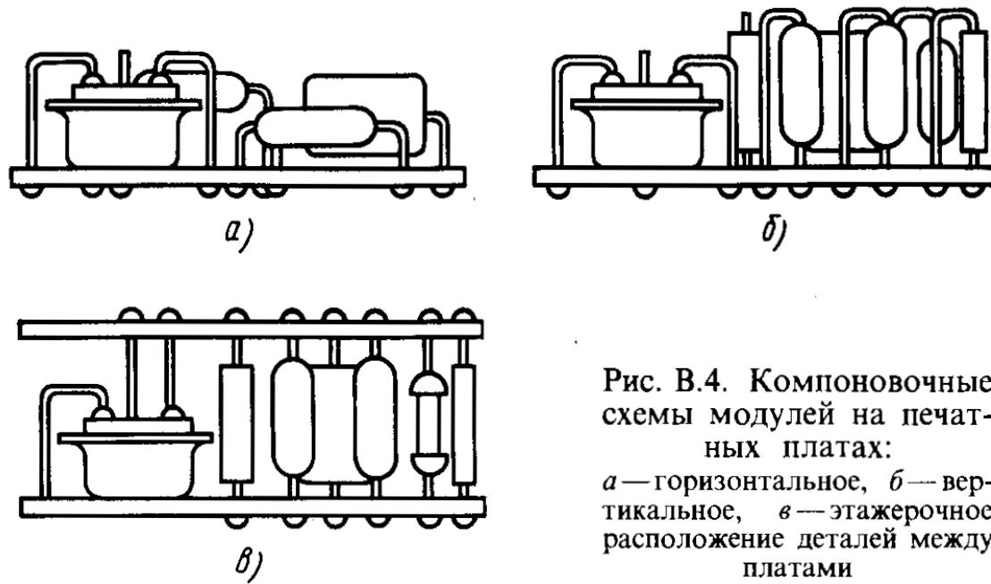
Рис. В.4. Компоновочные схемы модулей на печатных платах:
