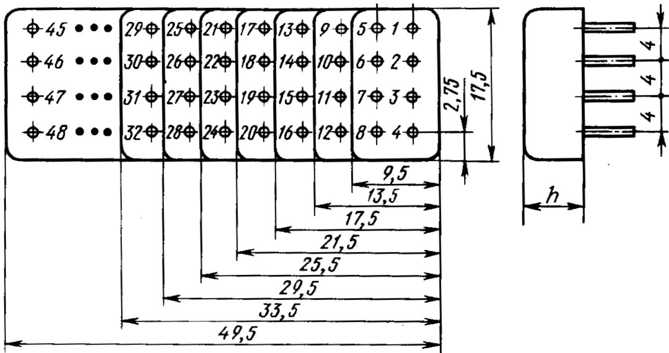
Рис. В.6. Унификация размеров плоских модулей ( $h=3,5\ldots10,5$  мм)
