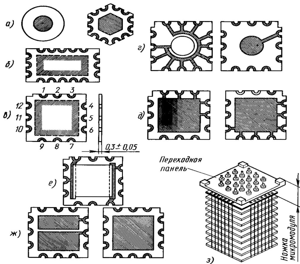
5. Характерная форма микроплат (а—е), примеры плат-полуфабрикатов (ж—ж), этажерочный микромодуль с 28 ленточными соединениями (з)
