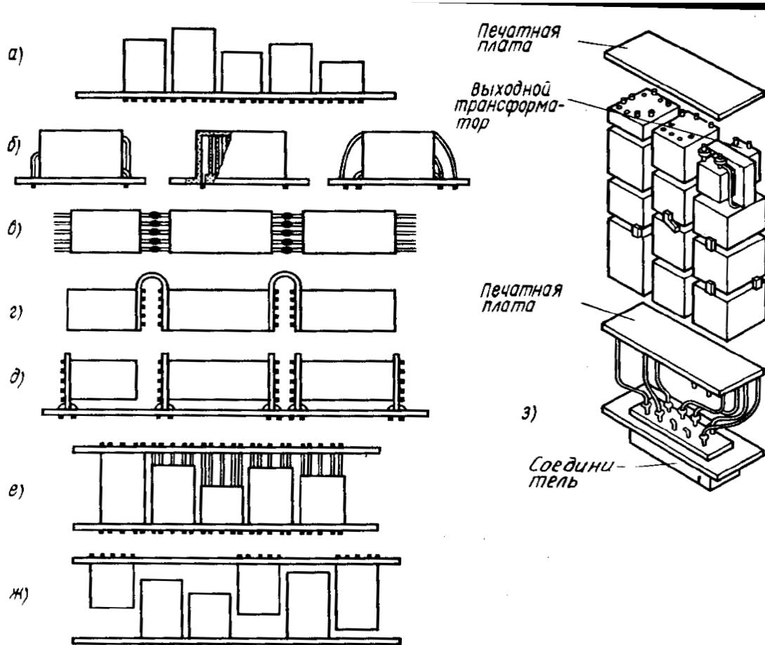
Рис. В.8. Варианты компоновки этажерочных микромодулей:
