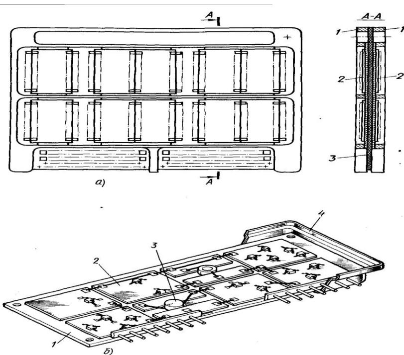
Рис. В.11. Конструкция узлов РЭС четвертого поколения:
