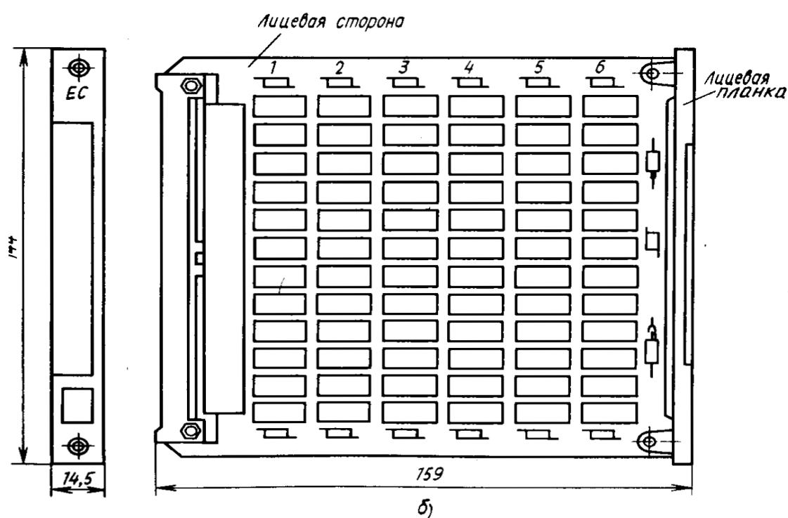
§.10. Логические типовые элементы замены ЕС ЭВМ на основе двусторонней (а) и многослойной (б) печатной платы
